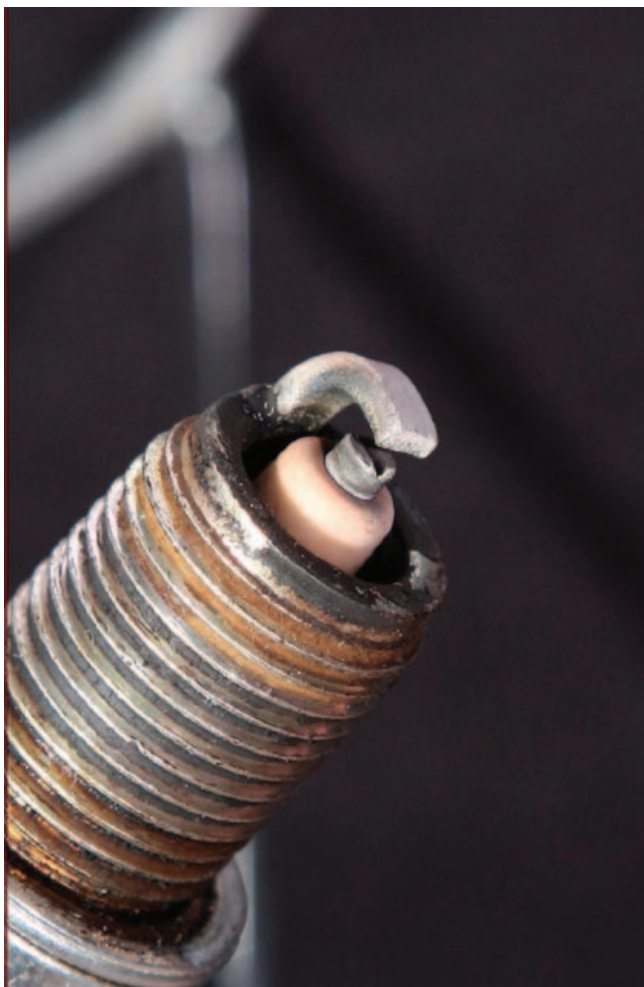
Высокозольные традиционные моторные масла с высоким щелочным числом могут приводить к появлению белых отложений на свечах зажигания газового двигателя
