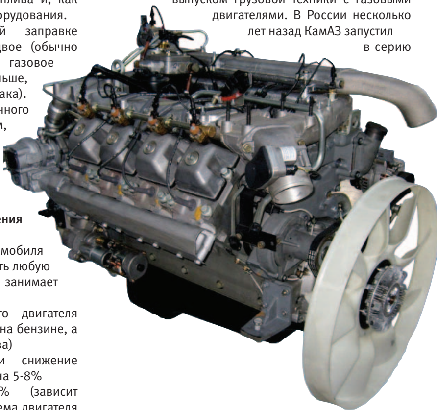
8-цилиндровый КамАЗ 820.60 мощностью 260 л.с. позволяет достичь экологических требований Евро-4. Устанавливается на пассажирскую, коммунальную и строительную технику
