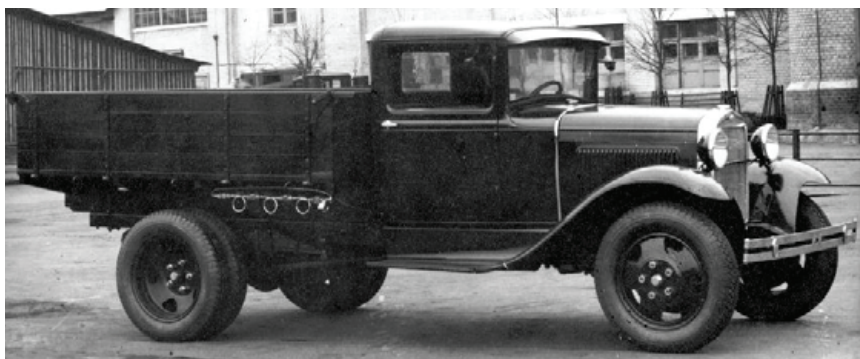
Газобаллонная версия ГАЗ-44 на сжиженном нефтяном газе. Баллоны с газом располагались под грузовой платформой. Выпущена малой партией в 1939 году
