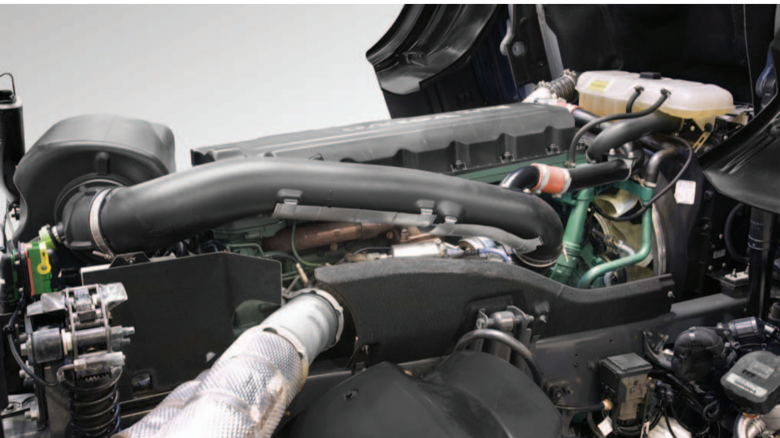
Газодизели нашли большее распространение в Европе, чем конвертированные дизели. VolvoTruck запустил в производство серию FM MethanDiesel на основе 13 литрового двигателя мощностью 460 л.с. Соотношение газа и запальной порции топлива - 75/25
